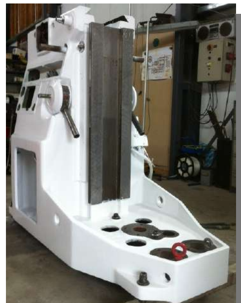
Grattage du bâti
