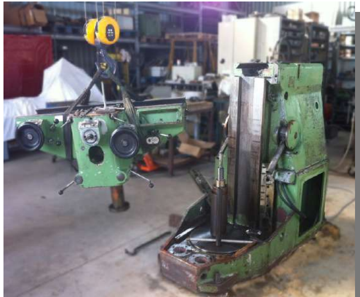
Démontage de la console
