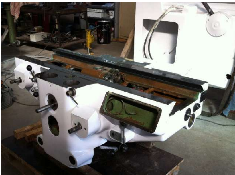
Démontage complet Remise en état complète et peinture
