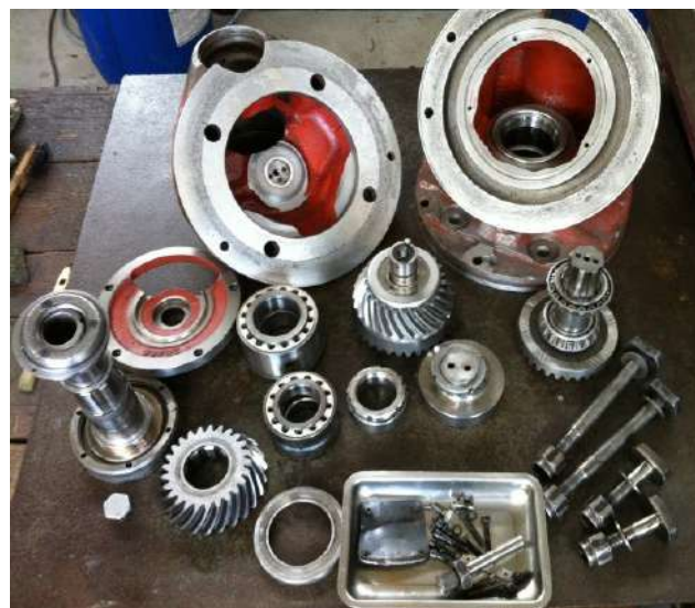
Remontage avec roulements neufs et éventuellement des Pignons spiro-coniques
