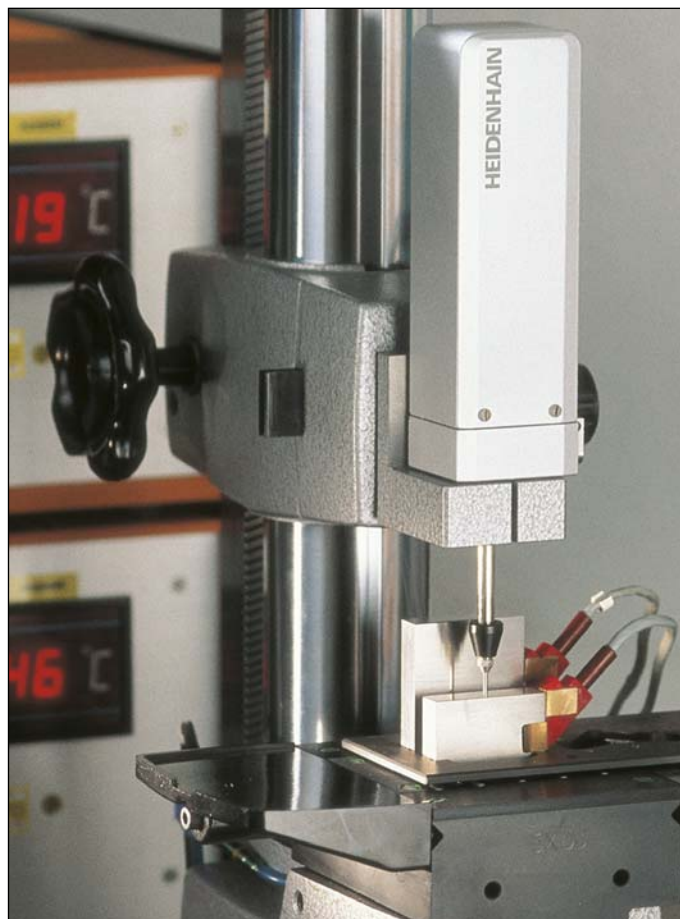
Étalonnage de cales-étalons
