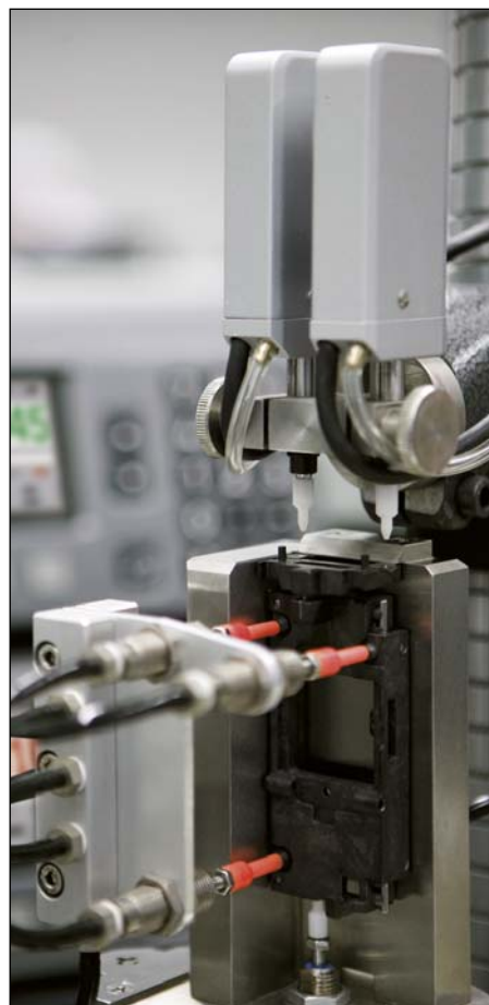
Acquisition de positions sur une table X/Y pour le montage de lentilles
